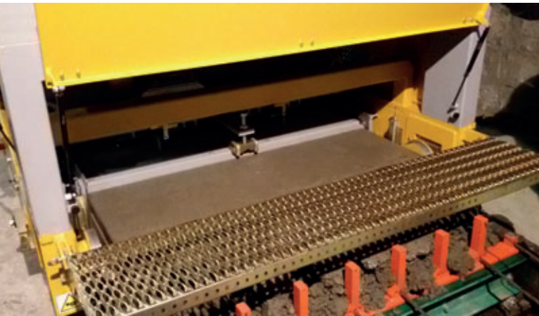
Bétonneuse-extrudeuse de la série evo 150 pour la fabrication de dalles alvéolées d'une largeur de 1,5 mètre
