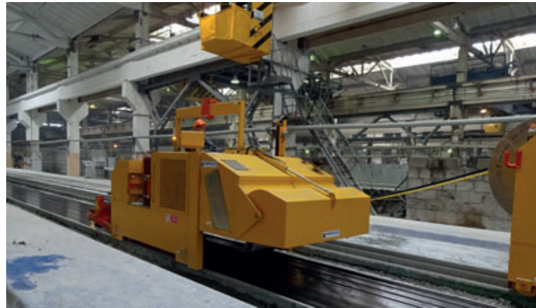
Dispositif de nettoyage multifonctionnel pour le nettoyage, le graissage et la pose d'acier de précontrainte
