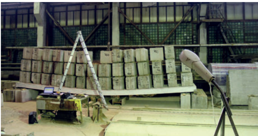
Contrôle de la capacité de charge dans l'usine KSK à Iwanowo
