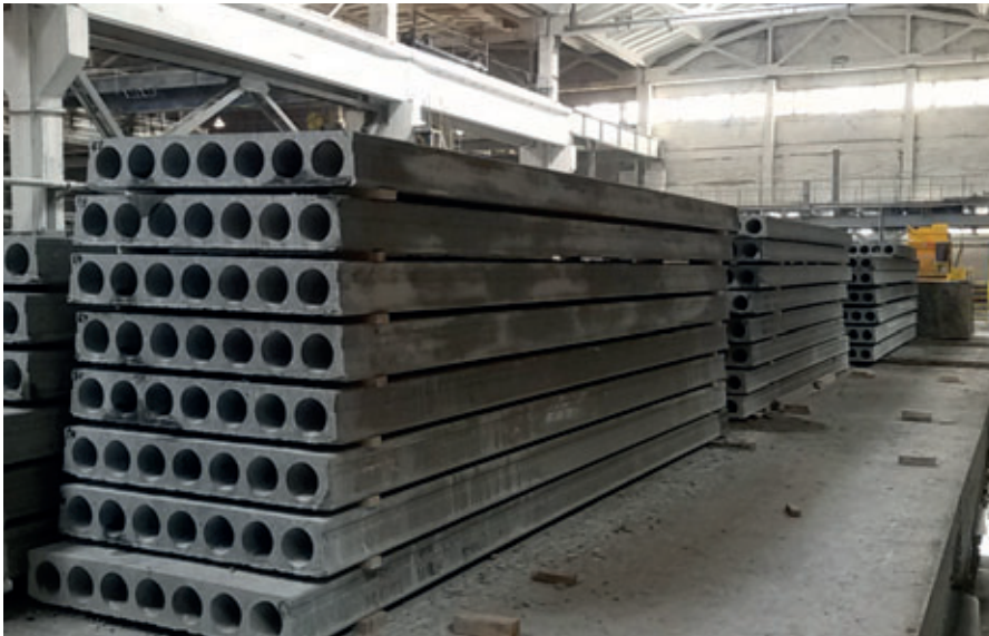
Stockage intermédiaire des dalles alvéolées
