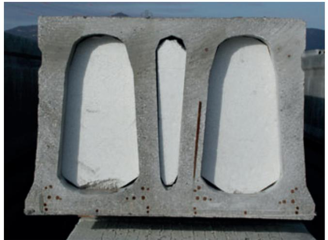
Seção transversal de um paver de 1000 mm de altura com as cordoalhas de tensionamento e as malhas de armadura assentes transversalmente relativas à direção de transporte.
