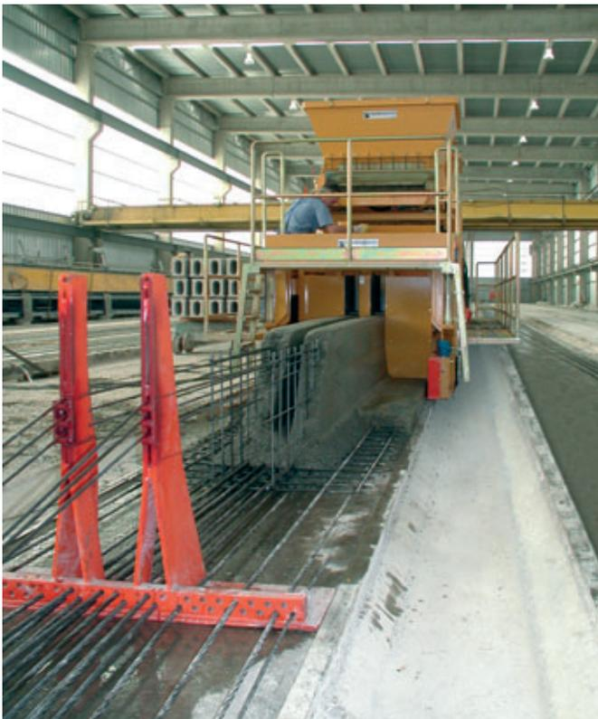
A moldadora deslizante de Nordimpianti durante a produção de vigas mestras TT de 1 metro de altura.
