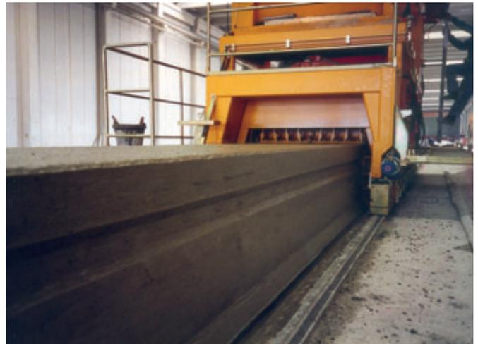
A moldadora deslizante de Nordimpianti durante a produção de lajes alveolares protendidas de 1 metro de altura.
