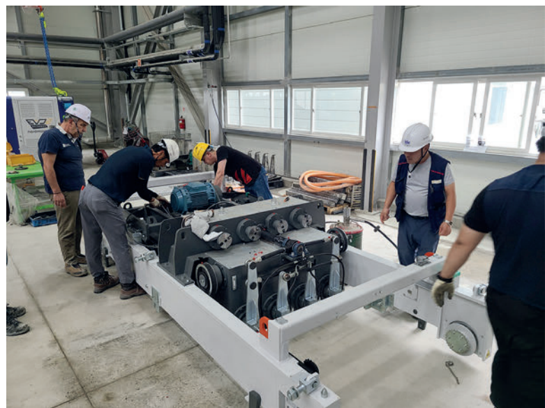
Personal de GPC en la planta, examinando el engranaje en baño de aceite
