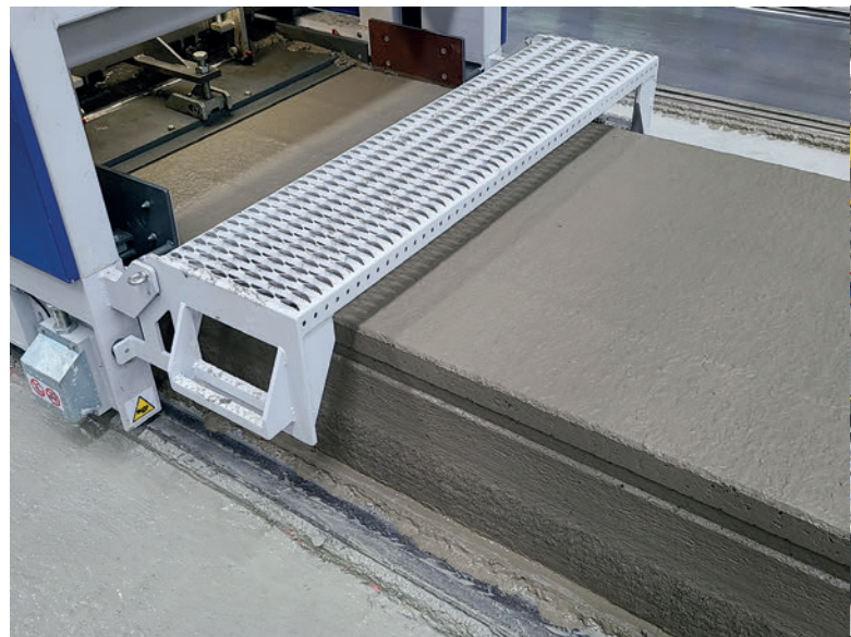
Hormigonado de placas alveolares pretensadas de 500 mm de alto
