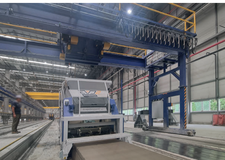
Extrusora EVO2 durante la producción en modo automático
