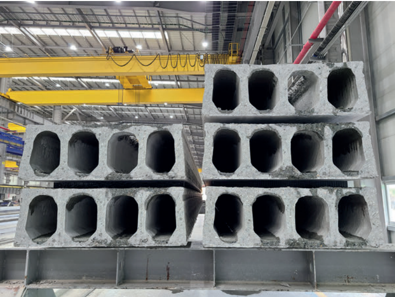
Las primeras placas alveolares producidas listas para el transporte a la zona de almacenamiento
