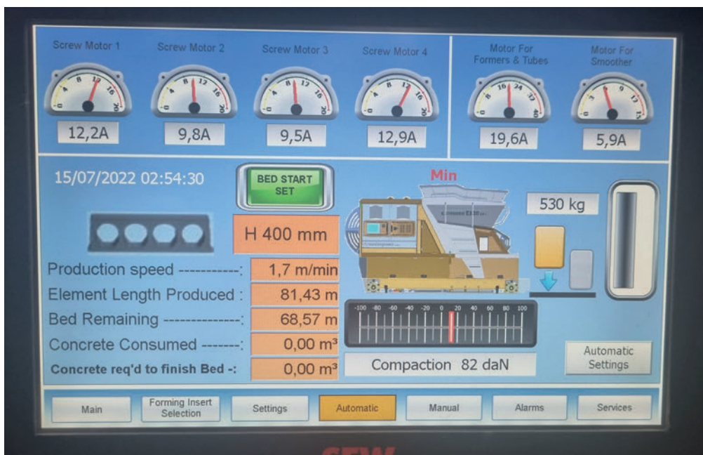
Panel de control HMI de la máquina extrusora con una velocidad de producción de 1,7 m/min para placas alveolares de 400 mm
