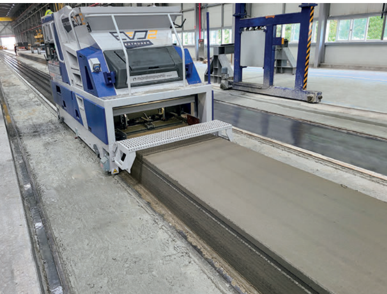
La extrusora EVO2 durante la producción de placas alveolares con una altura de 400 mm
